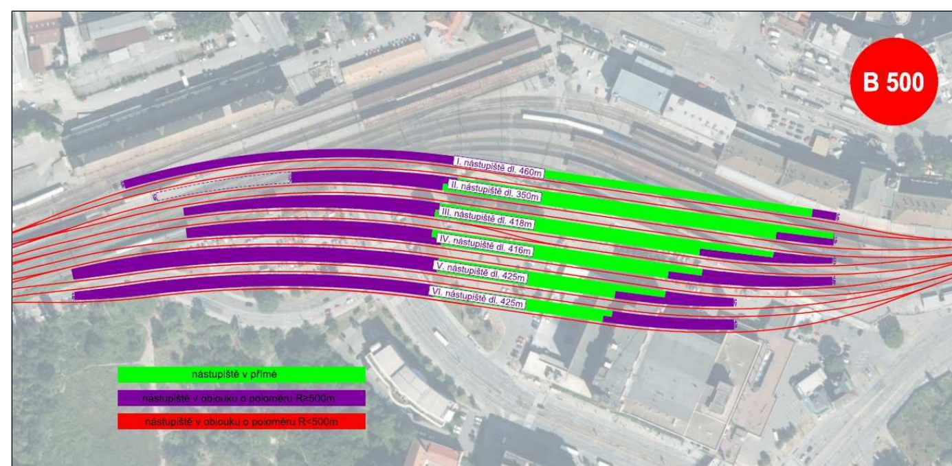
Obrázek 93 - Schématické znázornění křivosti nástupišť hlavního nádraží v řešení B500
